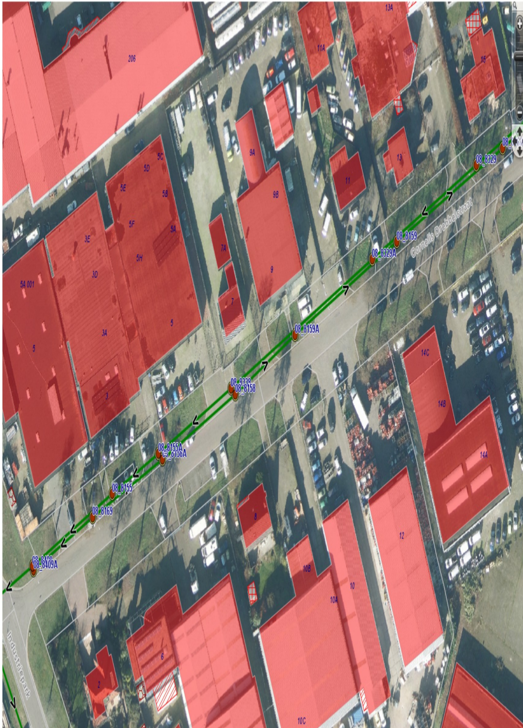
Figuur 1 Monsterlocaties aan de [redacted] in Wijchen. De groene lijnen geven de rioolleidingen weer: de noordelijke stroomt in zuidwestelijke richting, de zuidelijke in noordoostelijke richting. Deze zuidelijke rioolleiding is via een lus verbonden met de noordelijke. Het rioolwater verlaat de [redacted] in het zuidwesten bij rioolput 08_8409. Het bedrijf bevindt zich op nummer 12 en loost op beide rioolleidingen.
