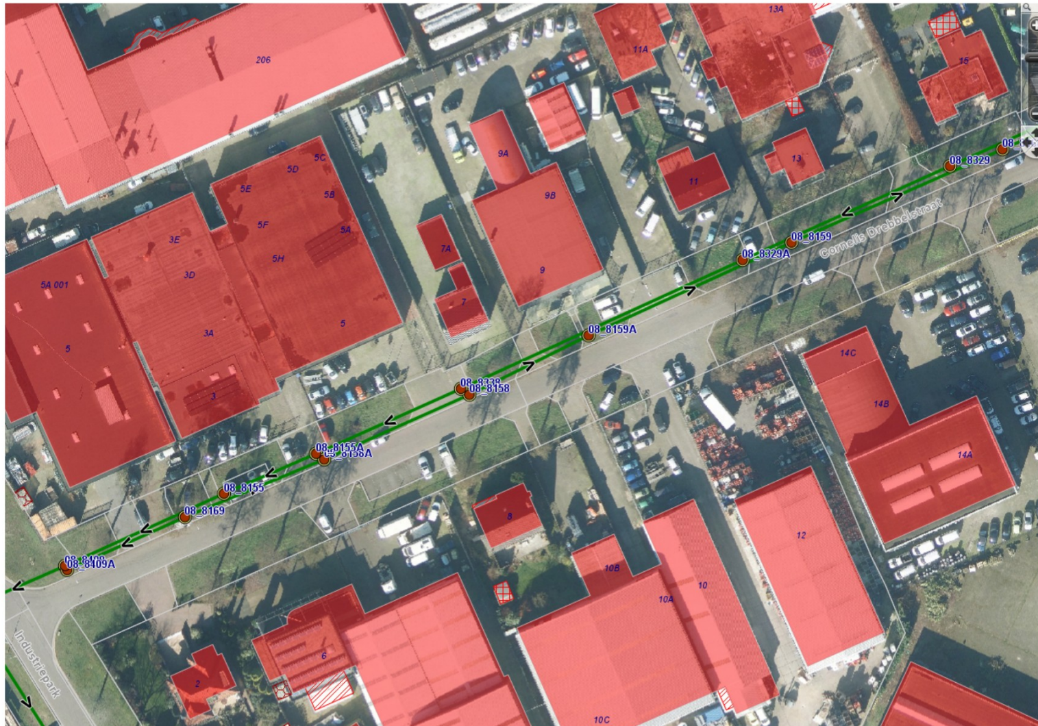
Figuur 1 Monsterlocaties aan de [redacted] in Wijchen. De groene lijnen geven de rioolleidingen weer: de noordelijke stroomt in zuidwestelijke richting, de zuidelijke in noordoostelijke richting. Deze zuidelijke rioolleiding is via een lus verbonden met de noordelijke. Het rioolwater verlaat de [redacted] in het zuidwesten bij rioolput 08_8409. Het bedrijf bevindt zich op nummer 12 en loost op beide rioolleidingen.
